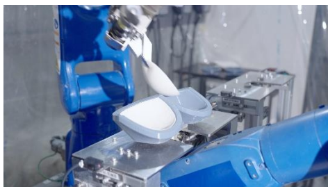
Melooop によるブラカップの生産工程。3Dプリンターで制作した型に繊維を吹き付け、成形後に型から取り外している様子
