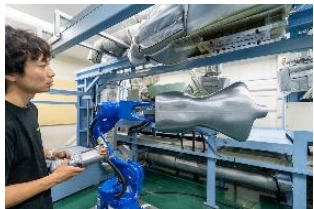
樹脂型に繊維を吹き付け 立体物を成形
