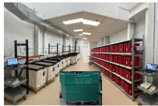
返品自動仕分けシステム (Put wall) の設置を完了 (22年9月)
